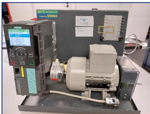
Figure 1: Motor eléctrico y variador
